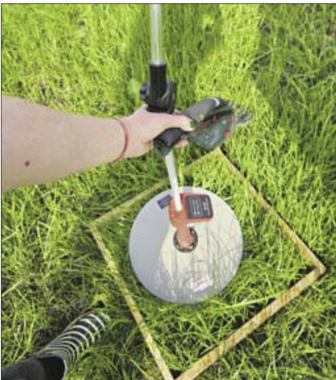
Slika 1: Digitalni platemeter Jenquip EC20 – izvedba poskusa tedenskega spremljanja prirastov travinja
