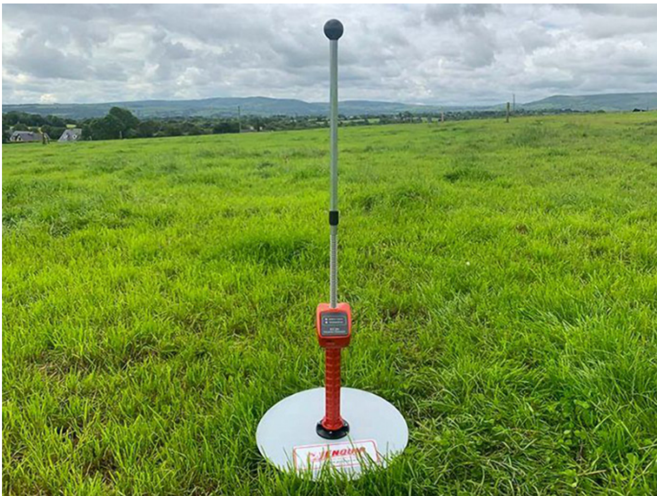
Slika 2. Digitalni platemeter Jenquip EC20
